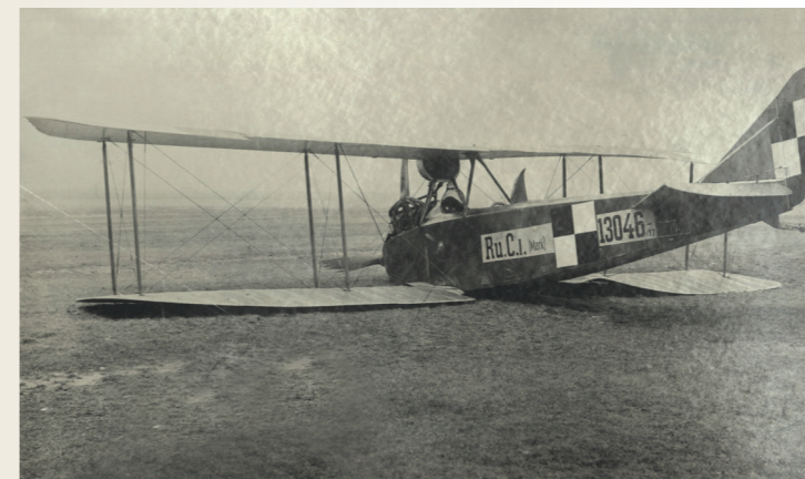
Poniemiecki samolot wywiadowczy Rumpler C.I w polskim malowaniu. Rumplery C.I w listopadzie 1918 r. zdobyto na lotnisku mokotowskim w Warszawie, a dwa miesiące później – na lotnisku Ławica pod Poznaniem. Maszyny Rumplera cieszyły się wśród pilotów nie najlepszą opinią. Stosunkowo łatwo wpadały w korkociąg. Na fotografii udokumentowano wypadek używanego przez Stację Lotniczą Ławica w pierwszej połowie 1919 r. samolotu nr 13046/17 (Cyfrowa Biblioteka Narodowa „Polona”)
